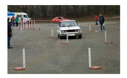
Vier versetzte Slalomtore im Abstand von jeweils 8 Metern ... gefahren im zweiten Gang bringt diese Aufgabe Fahrwerk und Fahrer an die Haft- und Belastungsgrenze. Die Breite der Tore richtet sich nach der Fahrzeugbreite und lässt den Fahrern nur etwa 25 cm Platz auf jeder Seite. Gesucht wird also der beste Kompromiss zwischen Geschwindigkeit und Genauigkeit.
